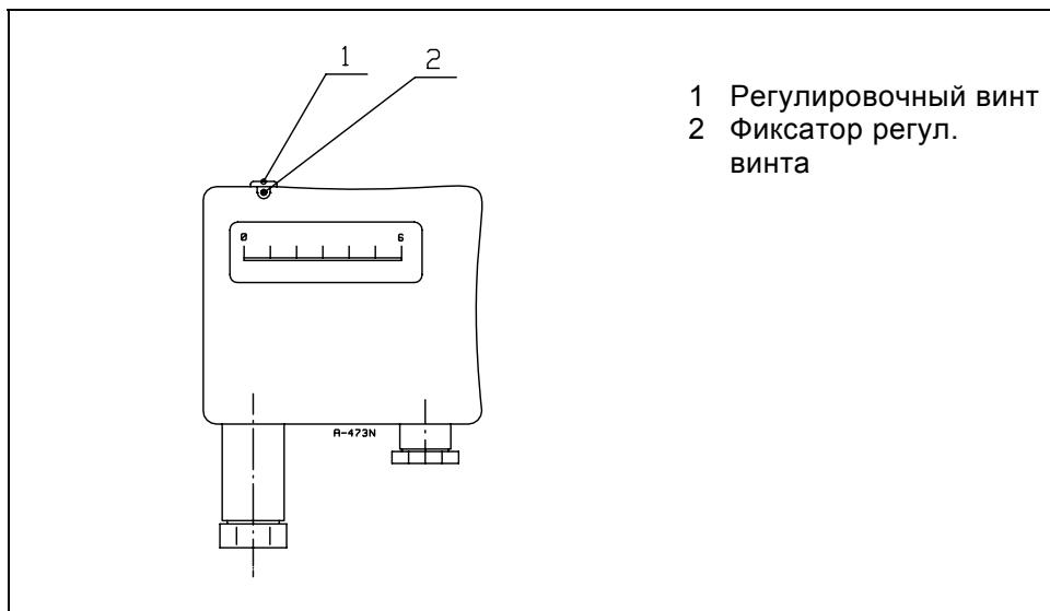
Реле максимального давления топлива контролирует давление топлива в возвратной трубе. Если давление превышает заданное значение ( заводская уставка 6 бар), горелка останавливается.
