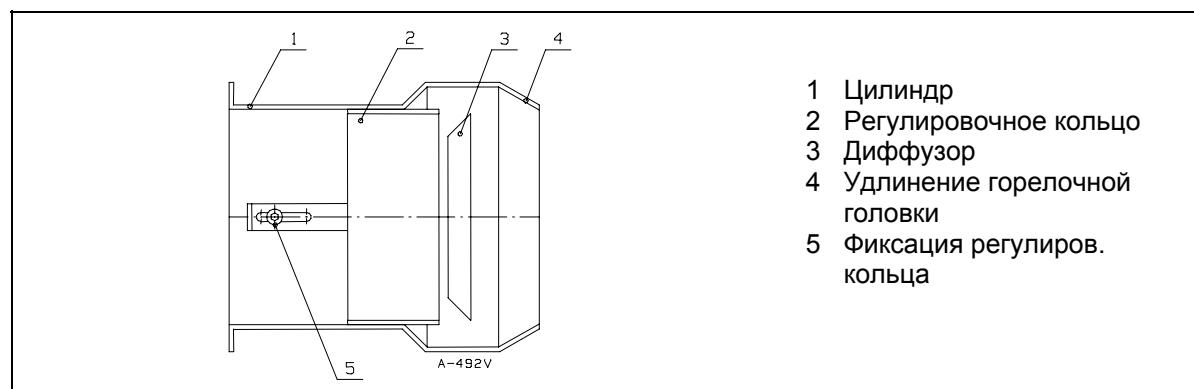
**Вним!** Если место кольца относительно диффузора меняется, также скорость и расход воздуха меняются. Проверьте результат сжигания анализом дымовых газов и подрегулируйте подачу воздуха.
