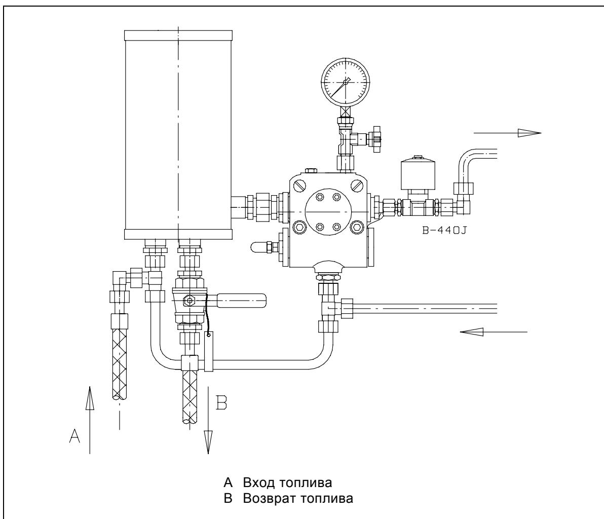
При монтаже деаэратора для удаления газа и воздуха из топлива, необходимо учитывать правильное направление течения топлива.
