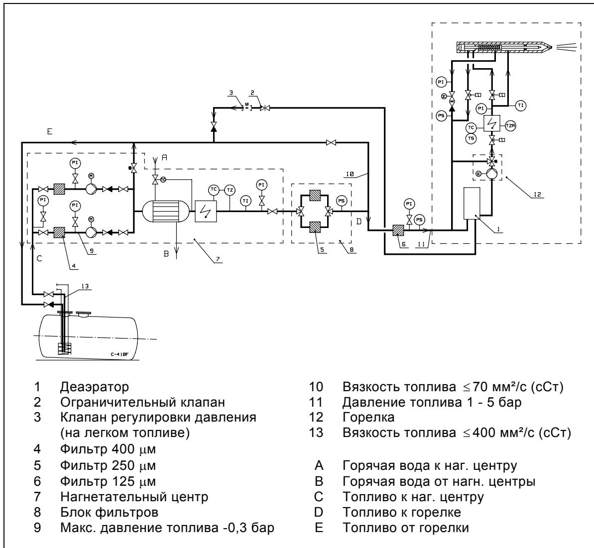
Производительность нагнетательного центра должна быть на 200 кг/ч выше сжигаемого количества топлива. Например, при производительности горелки 200 кг/ч  $\Rightarrow$  требуемая производительность нагнетательного центра ок. 400 кг/ч.
